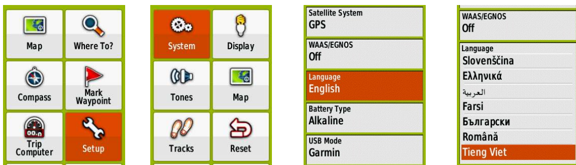
a) Thực đơn chính b) Thực đơn Cài đặt c) Thực đơn hệ thống d) Thực đơn ngôn ngữ Hình 14. Cài đặt ngôn ngữ tiếng Việt (không dấu) trong máy Garmin eTrex 20x
